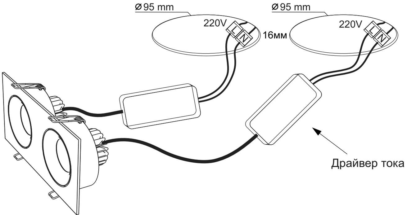
**ВАЖНО:** Установка светильника должна производиться при обесточенной электросети.
